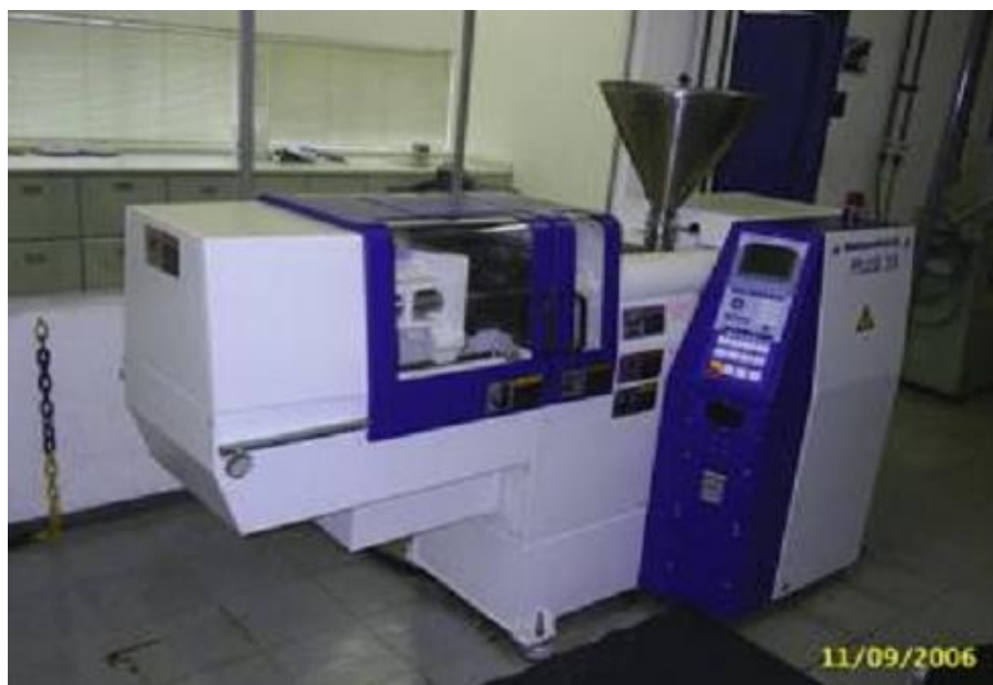
Figura 2 – Injetora Battenfeld usada para obtenção dos corpos de prova.
